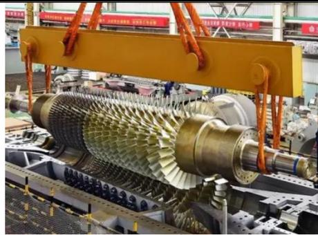
压缩机-汽缸、转子、叶轮
