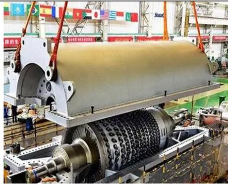
压缩机-汽缸、转子、叶轮
