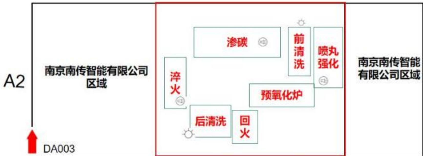
图 2.2-2 原环评热处理车间平面布置图
