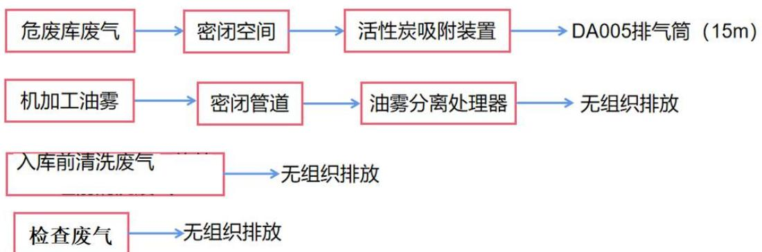
图 4.2-2 变动后废气收集处理流程图
