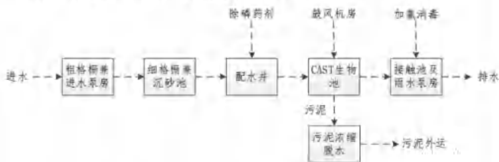
图4-3: 仙林污水处理厂二期工艺流程图
